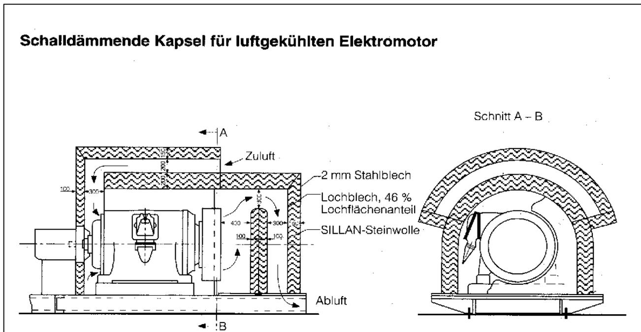
Bild 11: Prinzipskizze – Luftführung bei einem gekapselten Kompressor
