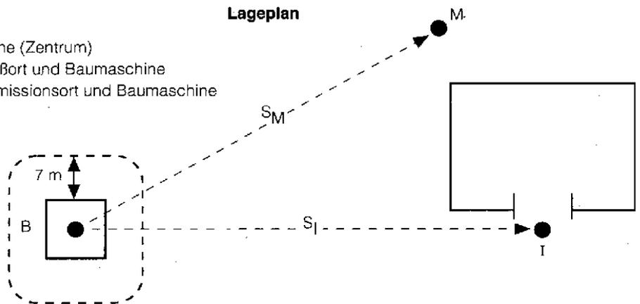
1) Nach der Formel  $v = \frac{S_M}{S_I}$  ist das Verhältnis der Entfernungen zwischen dem Meßort und der Baumaschine und zwischen dem Immissionsort und Baumaschine zu bilden:
