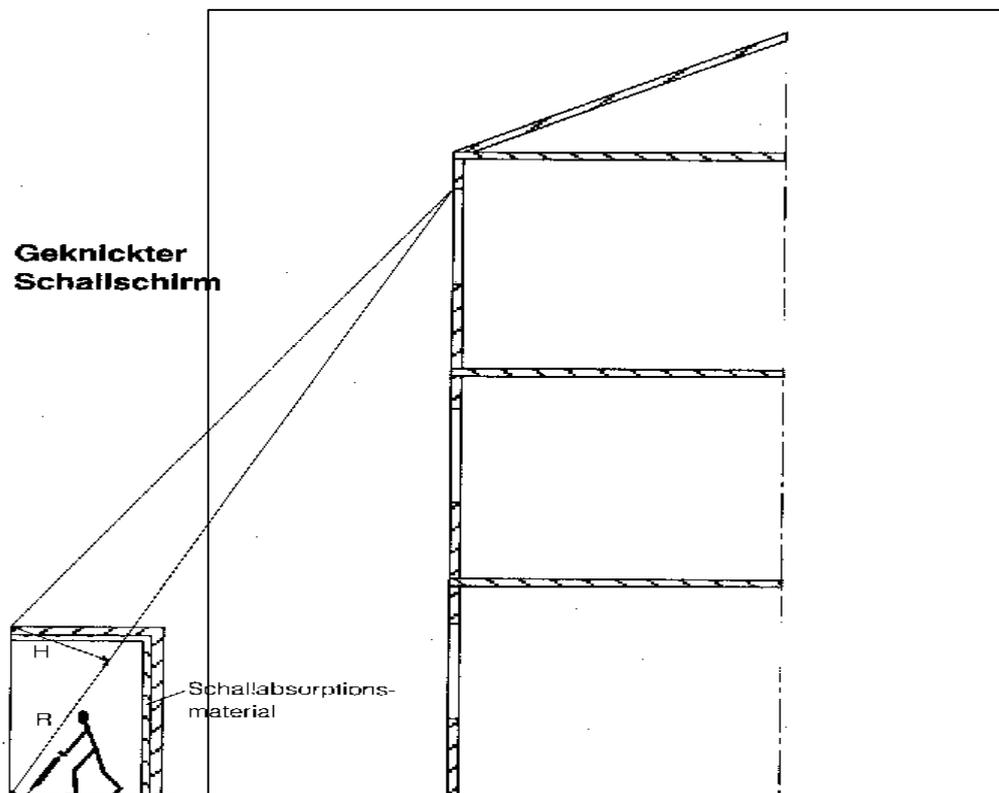
**Bild 6:** Prinzipskizze – Schallschutzschürze für Presslufthammer
